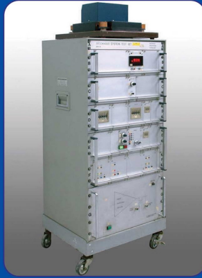
دستگاه اندازه گیری خواص مغناطیسی فولادهای الکتریکی (دستگاه تست ایشنتین)
