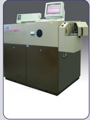
دستگاه آنالیز فلزات Quantometer , ARL - 3460
