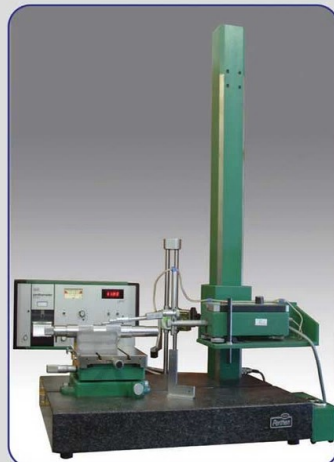
دستگاه اندازه گیری زبری (صافی) سطوح
