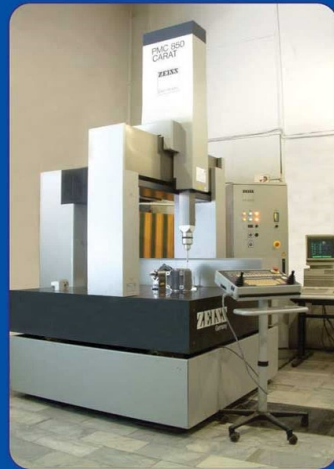
دستگاه اندازه گیری سه بعدی C.M.M
