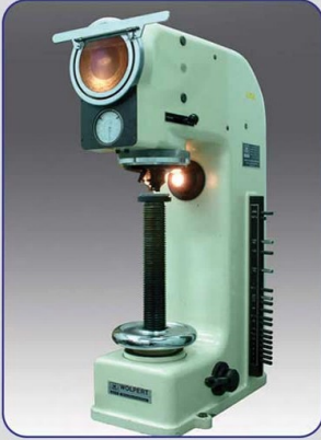
دستگاه سختی سنج WOLPERT-Hardness Tester
